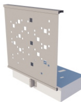
POSE CONTRE DALLE
